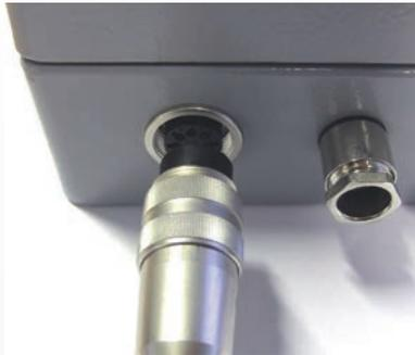
Geringer Aufwand beim Tausch des Sensors und der Auswerteeinheit durch schraubbare Steckverbindung – auch bei laufendem Betrieb möglich
