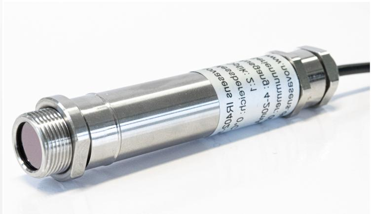
Der Infrarot Temperatur Sensor novasens IR402 misst berührungslos Temperaturen von  $-20^{\circ}\text{C}$  bis  $250^{\circ}\text{C}$  und ist mit einem Thermoelement-Ausgang des Typs T oder J oder K ausgestattet. Dieser Ausgangsbereich ist kompatibel mit fast jeder Maschinensteuerung, PIB-Controller, Anzeigergerät, Datenlogger, welche einen Thermoelementeingang aufweisen.
